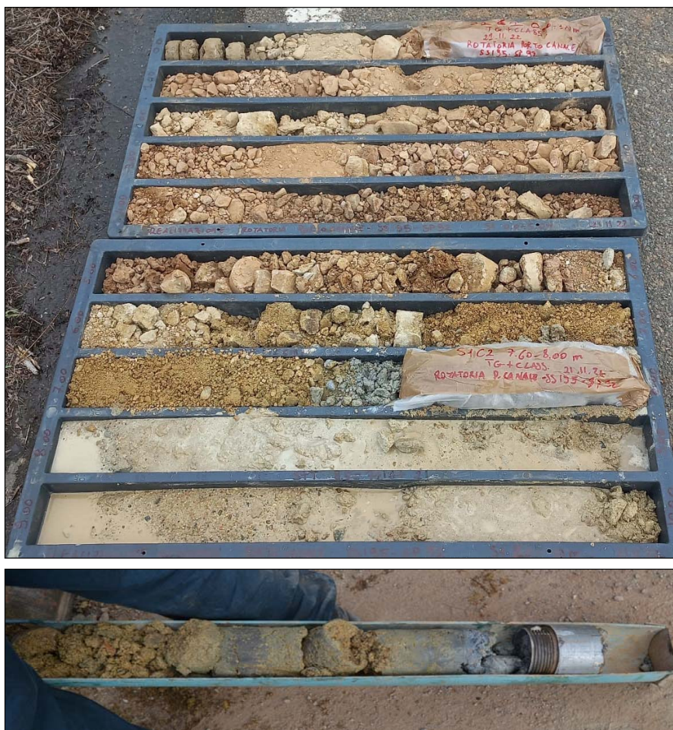
Foto 4.2 – in alto terreni estratti in S1 alla profondità 0,0 ÷ 10,0 m dal p.c. In basso fasi di estrazione del campione di terreno dal carotiere semplice
