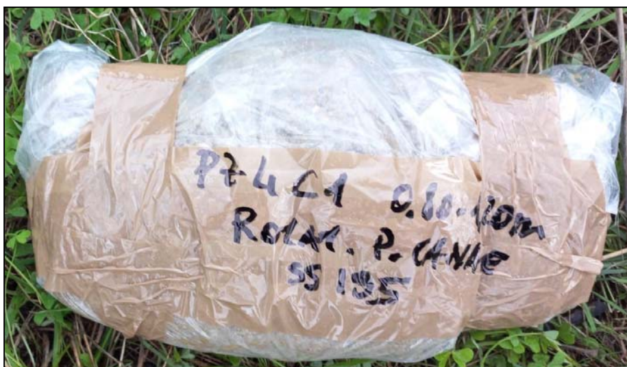
Foto 4.6 – Campioni di terreno prelevati nel corso delle indagini
