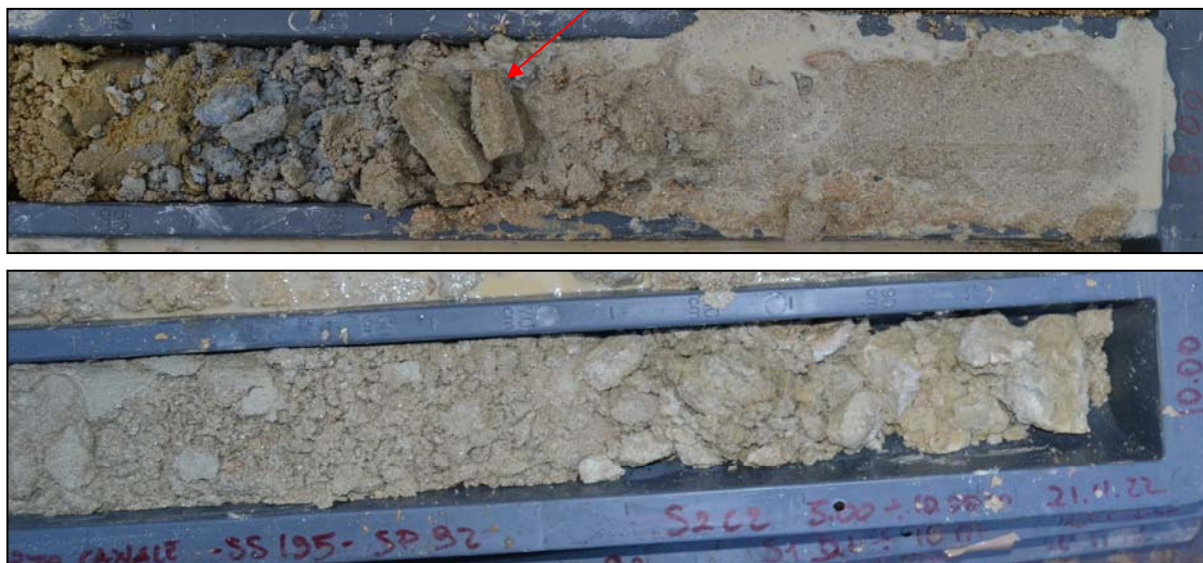
Foto 5.7: Sabbie di spiaggia dello Strato B2 rinvenute tra -7,5 ÷ -8,0 m in S1; con la freccia rossa livello cementato In basso sabbie di spiaggia dello Strato B2 rinvenute tra - 9,2 m ÷ -10,0 m in S1;
