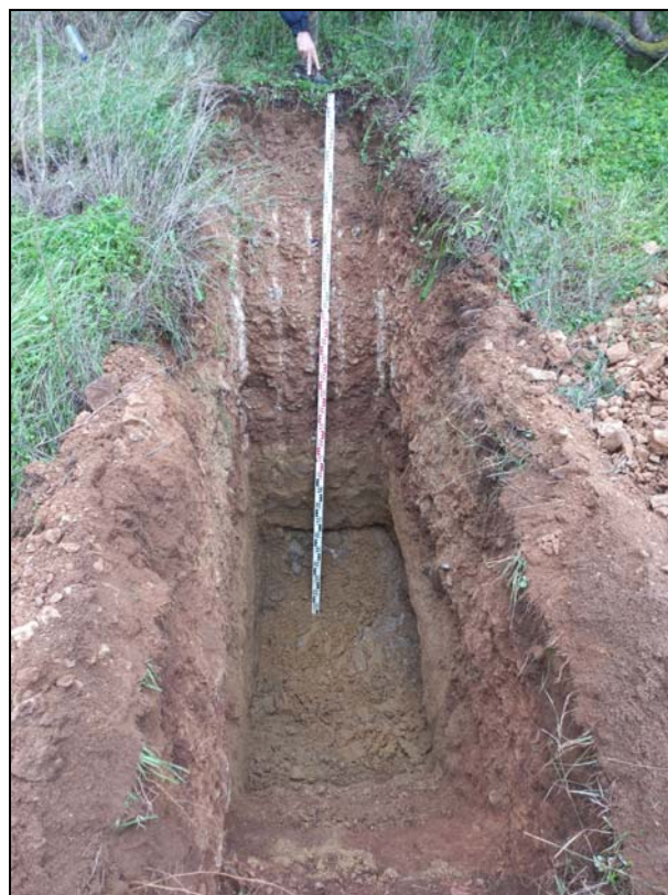
Foto 4. 3 – Posizionamento PZ2 e a destra stratigrafia dei terreni attraversati
