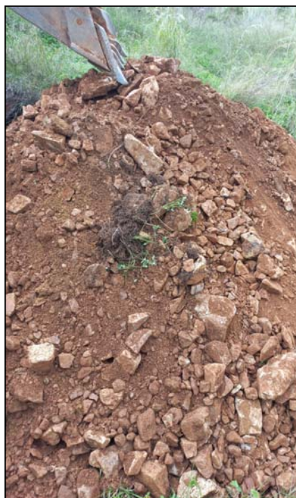
Foto 5.3: Sabbie con ghiaia dello Strato A2 rinvenute tra 0,0 ÷ -1,5 m in PZ1; a destra particolare
